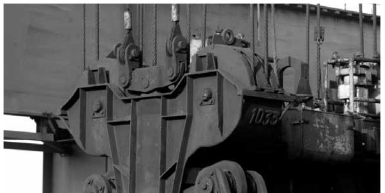
Bij de grote hijskranen van Tata Steel worden de snaarwielen gebruikt om een heel zwaar gewicht te kunnen tillen.
